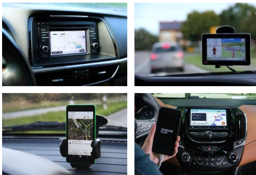
Figuur 11 Soorten navigatiesystemen (van linksboven naar rechtsonder): een ingebouwd navigatiesysteem, een nomadisch navigatiesysteem, een smartphone met een navigatie-app en een app die op het dashboard wordt weergegeven (Apple CarPlay, Android Auto).
